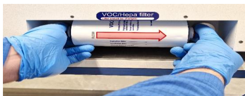
Obrázek 12.2 Postup vkládání a vyjímání filtru VOC/HEPA
